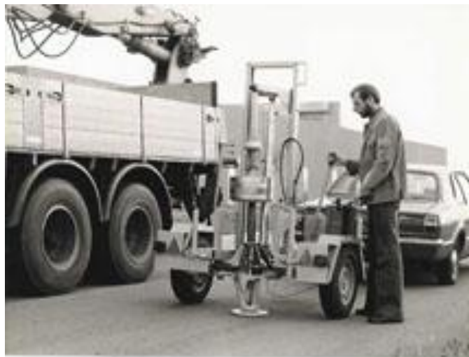
Rysunek 2.18 Ugięciomierz dynamiczny FWD A/S Phønix 1978 r. ( www.pavement-consultants.com )
