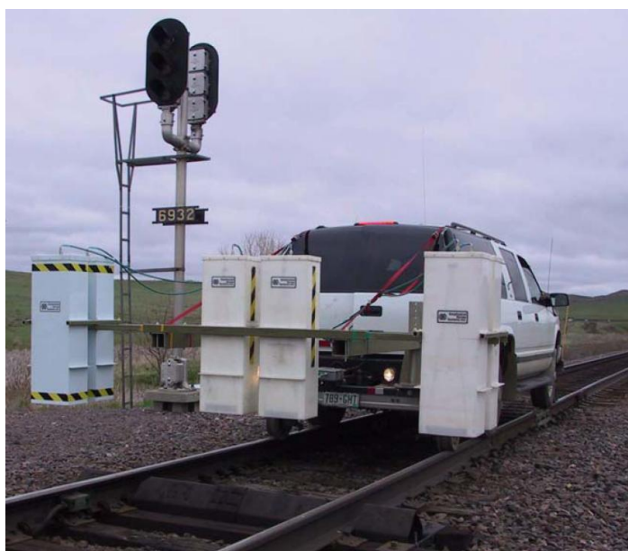
Rysunek 2.16 Pomiar stanu podtorza antenami typu horn o częstotliwości 1 GHz
