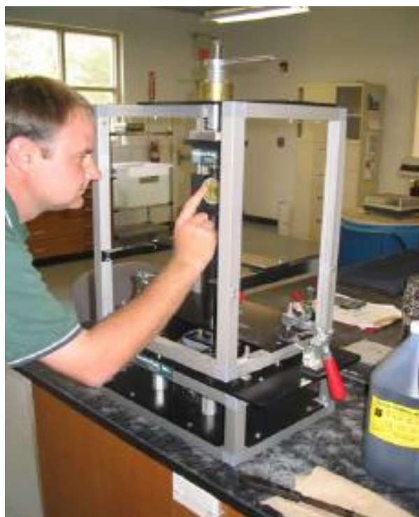
Rysunek 2.51 Aparat ATTACKER do badania szczepności międzywarstwowej (West, Zhang, & Moore, 2005)
