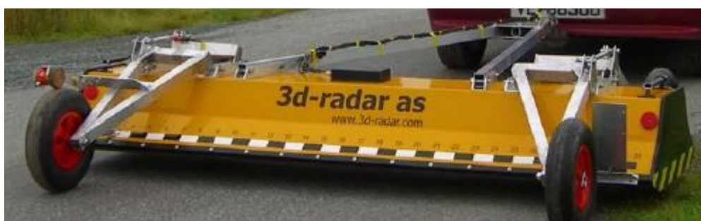
Rysunek 2.13 System pomiarowy norweskiej firmy 3D Radar (antena 63 elementowa typu stepped frequency o zmiennej częstotliwości od 30MHz do 2 GHz)
