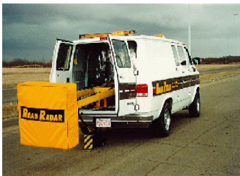
Rysunek 2.12 System pomiarowy kanadyjskiej firmy Road Radar (antena typu horn o częstotliwości 3 GHz i antena typu ground-coupled o częstotliwości 1 GHz)
