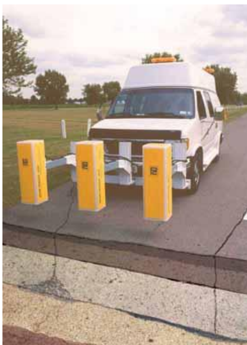
Rysunek 2.11 System pomiarowy amerykańskiej firmy Penetradar (anteny typu horn o częstotliwościach 1 GHz)
